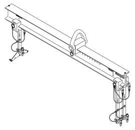
Model: 08-0130-4000 PW-530A & PW-545A Engine Sling
