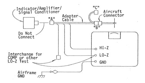
Figure 6 INSULATION TEST, CONFIGURATION #1
