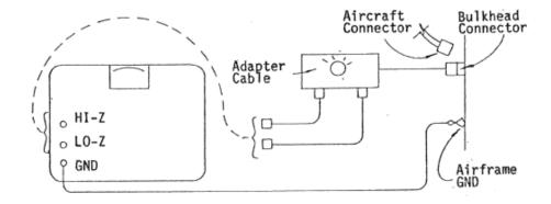
Figure 9 INSULATION TEST, CONFIGURATION #4
