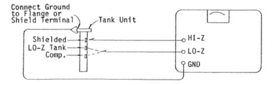
Figure 8 INSULATION TEST, CONFIGURATION #3
