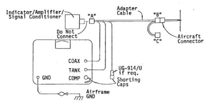
Figure 10 CONFIGURATION OF CAPACITANCE TEST
