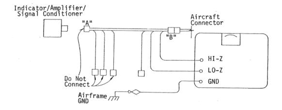
Figure 7 INSULATION TEST, CONFIGURATION #2
