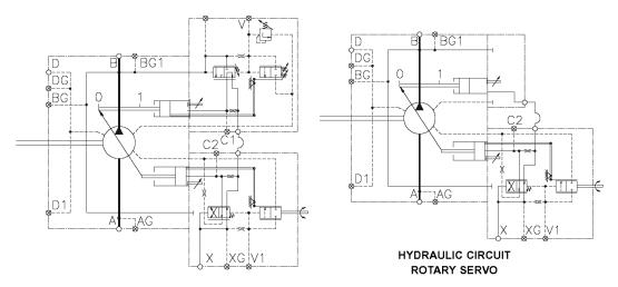
HYDRAULIC CIRCUIT ROTARY SERVO TORQUE LIMITER OVERRIDE
