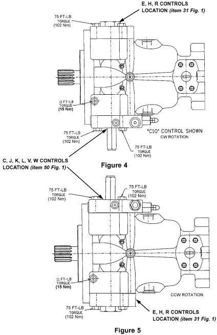
CONTROL ORIENTATION VERSUS PUMP ROTATION
