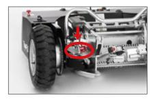
Bolzen zur Sicherung des Drehtellers
